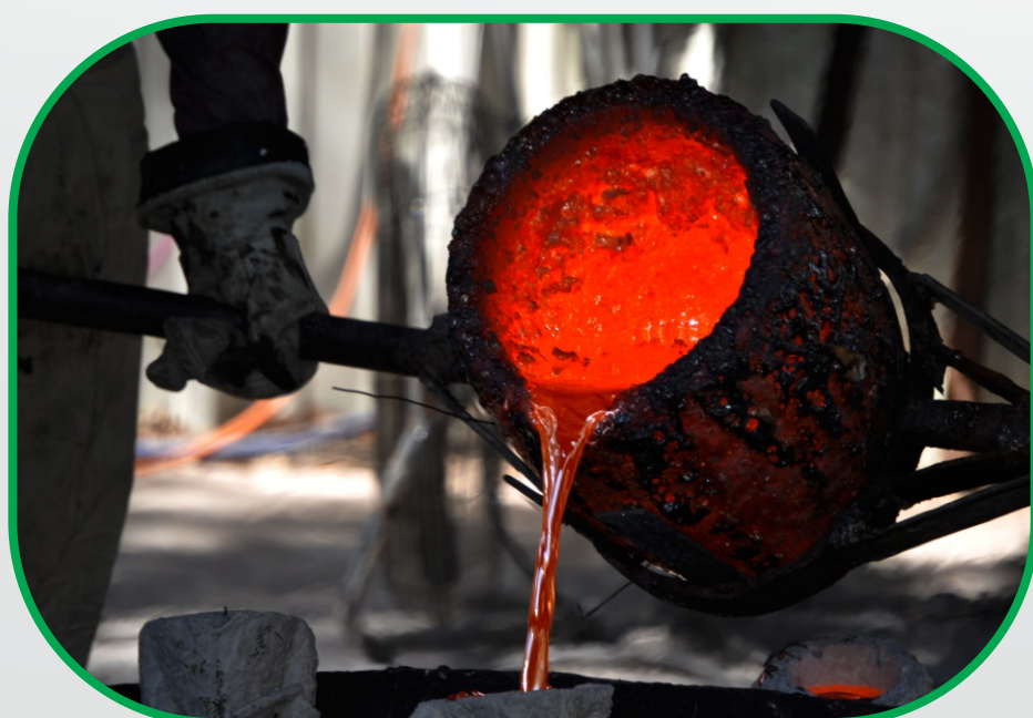
ریخته گری آلیاژ هاك برنزك مربوط به ژورنال بیرینگ هاك پمپ هاك دور بالا
